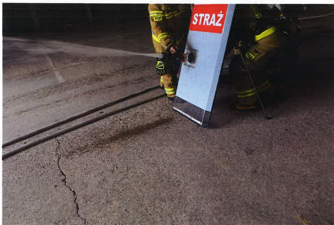
Fot. 4. Tarcza w trakcie testów – sprawdzenie współpracy z prądownicą.
