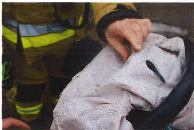
Fot. 7. Otwory w poduszce po kontrolowanym wyzwoleniu poduszki. Źródło: CNBOP-PIB.
