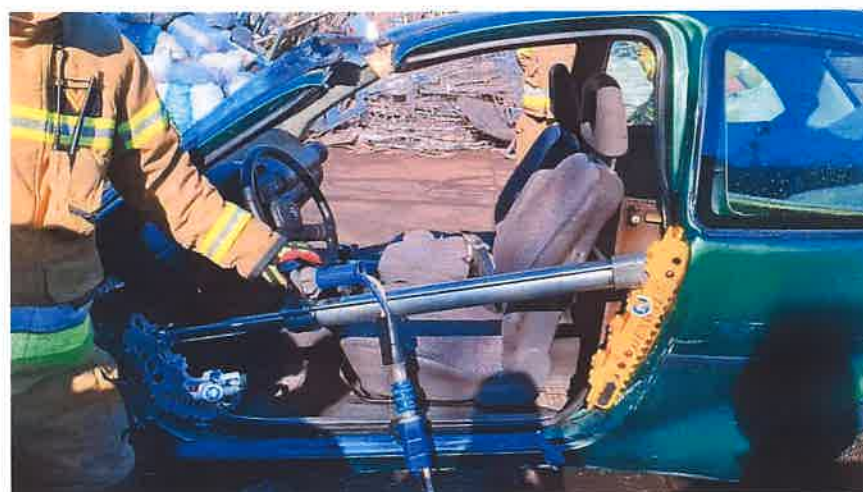
Fot. 8 i 9. Zastosowanie wspornika kąтового 80° i 180° Źródło: CNBOP-PIB.
