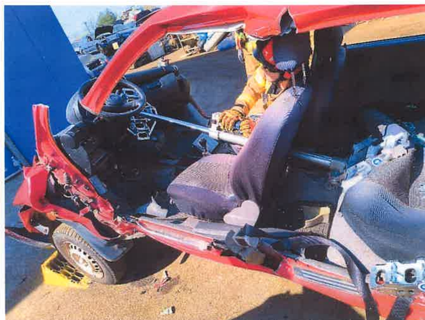
Fot. 15. Zastosowanie dwóch wsporników krzyżowych do wypchnięcia kokpitu pojazdu Źródło: JRG Oława.
