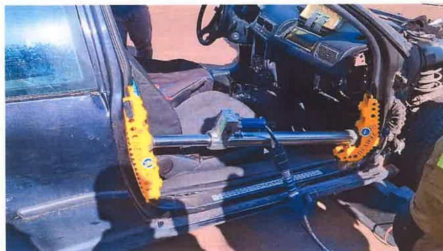
Fot. 12 i 13. Zastosowanie wspornika kąтового 90° i 180° Źródło: CNBOP-PIB.
