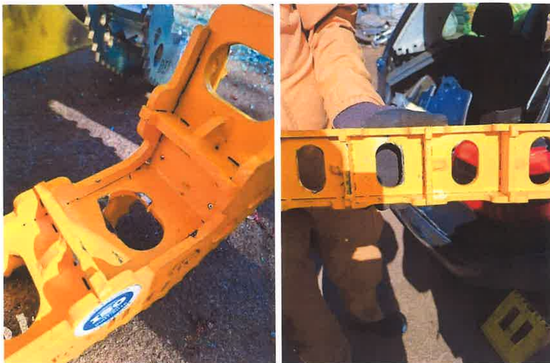
Fot. 16 i 17. Uszkodzenia powłoki antykorozyjnej wsporników Źródło: CNBOP-PIB.
