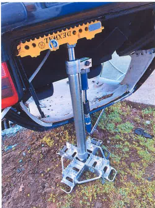
Fot. 15. Zastosowanie wspornika krzyżowego i wspornika kątowego do stabilizacji pojazdu Źródło: CNBOP-PIB.
