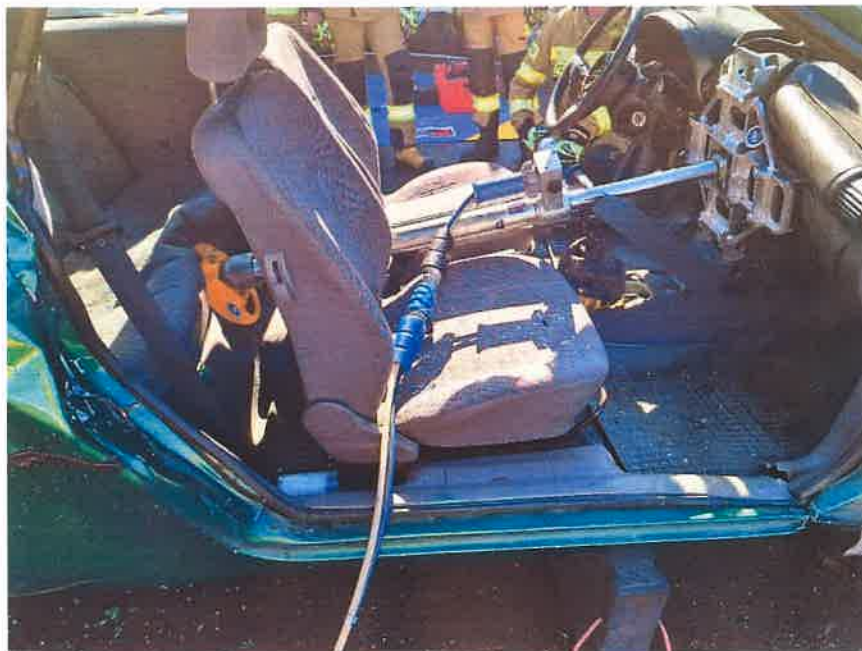
Fot. 14. Zastosowanie podpory płaskiej i wspornika krzyżowego do wypchnięcia kokpitu pojazdu Źródło: CNBOP-PIB.
