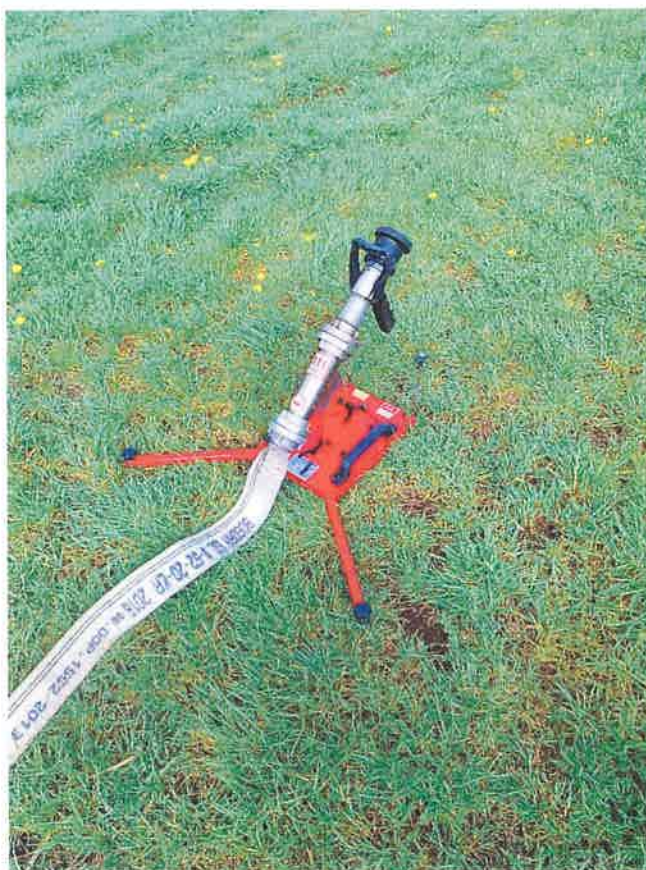
Fot. 2. Widok samodzielnego stanowiska gaśniczego z prądownicą turbo-jet.
