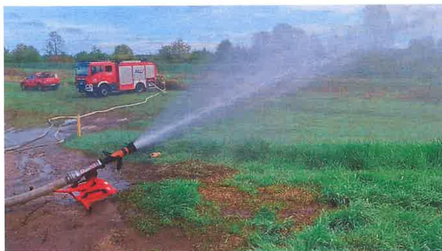
Fot. 5. Widok samodzielnego stanowiska gaśniczego z prądownicą turbo-jet i przytączem – podawanie wody z zagiętego węża W75. Źródło: CNBOP-PIB
