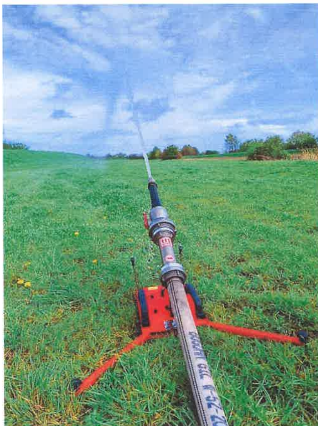
Fot. 3. Widok samodzielnego stanowiska gaśniczego z prądownicą prostą. Źródło: CNBOP-PIB
