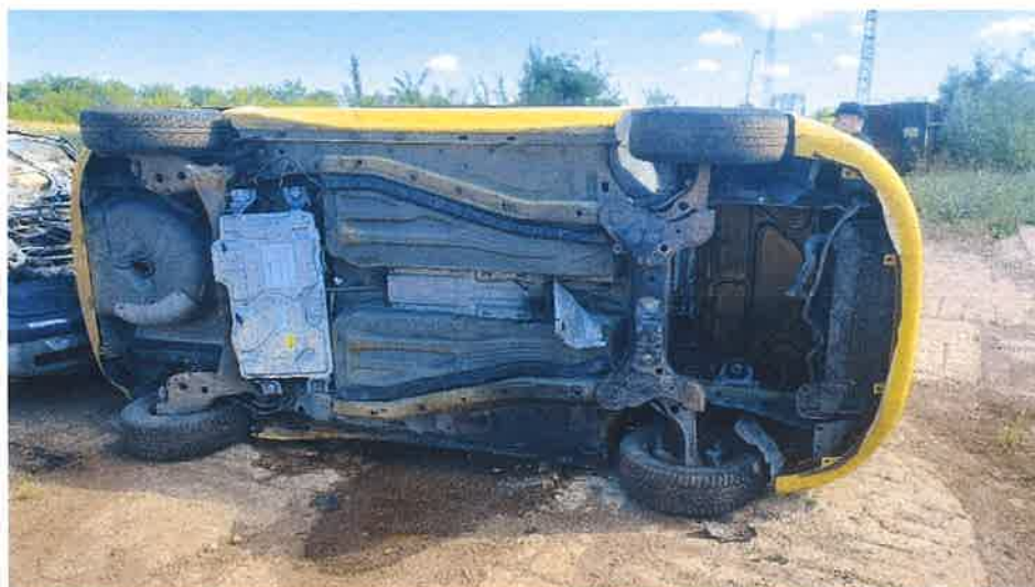
Fot. 3. Widok podwozia z pojazdu z zamocowanym akumulatorem
