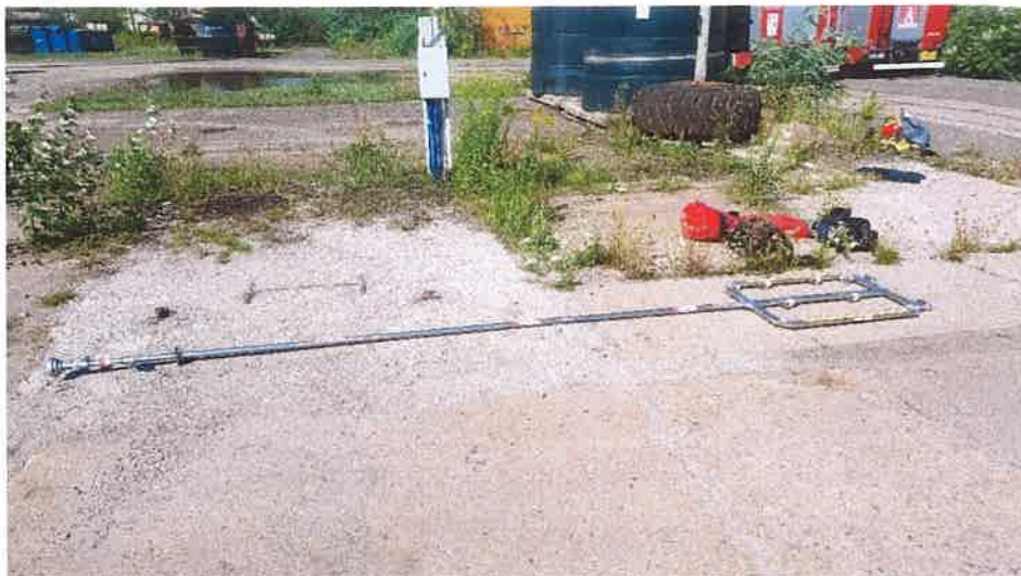
Fot. 2. Platforma gaśnicza do baterii pojazdów elektrycznych Źródło: CNBOP-PIB.
